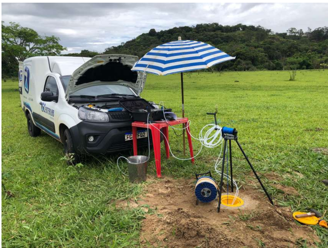
Figura VII: Amostragem da Água Subterrânea do PM-01 Novo
