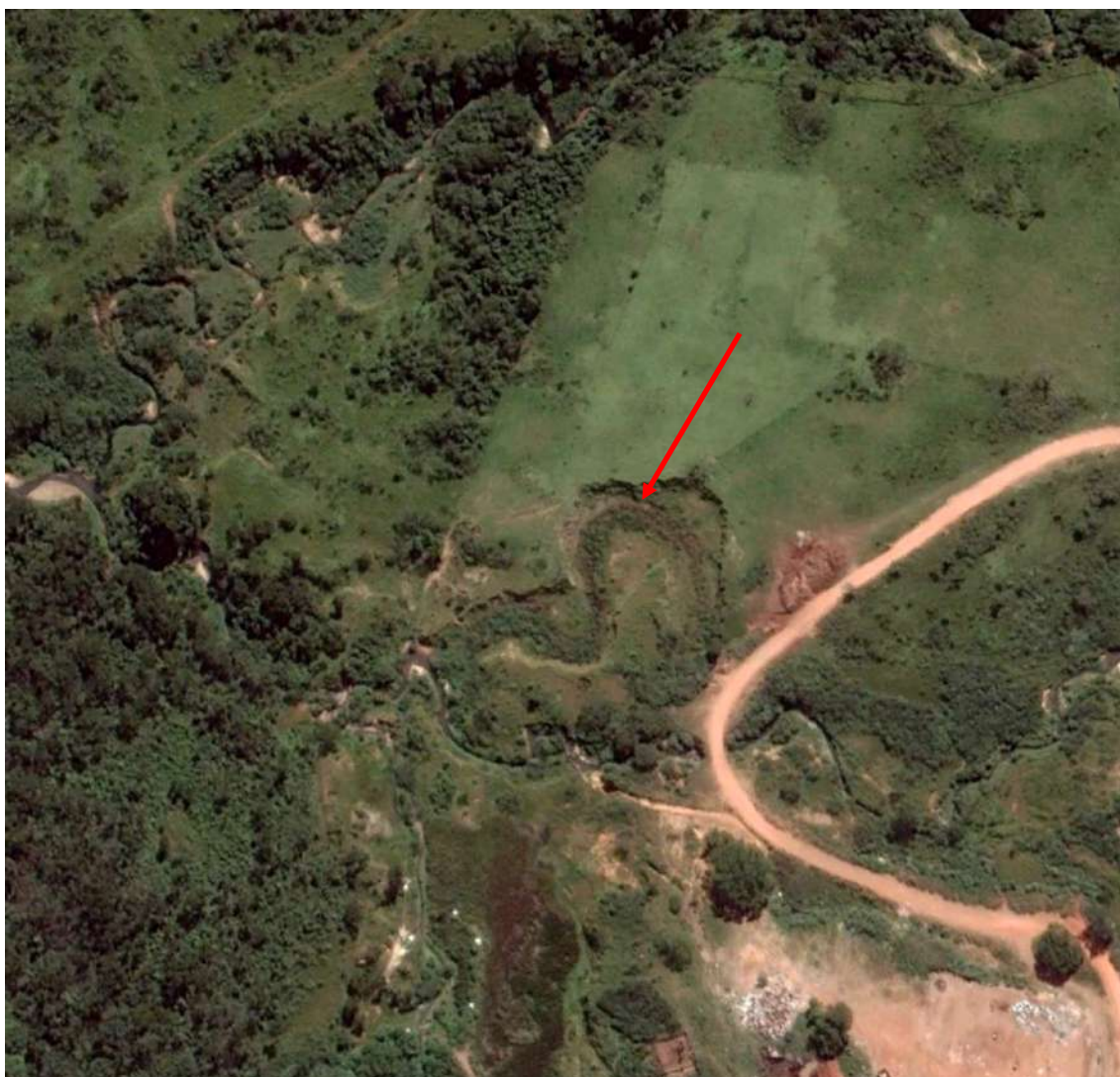
Figura XXXIV: Imagem aérea de 01/04/2012 mostrando a antiga cava de extração de sedimentos sem preenchimento (seta vermelha) e o retorno do fluxo fluvial para o leito original Fonte: Google Earth
