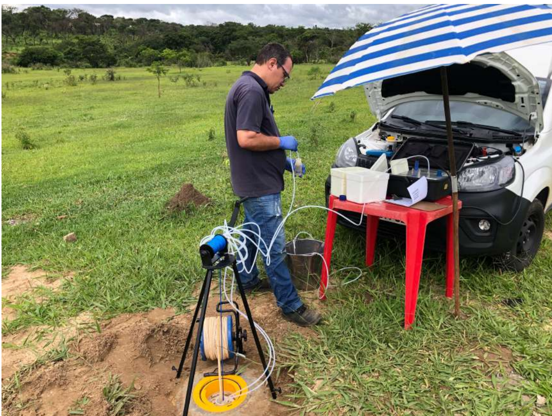
Figura IX: Coleta da Água Subterrânea no PM-01 Novo
