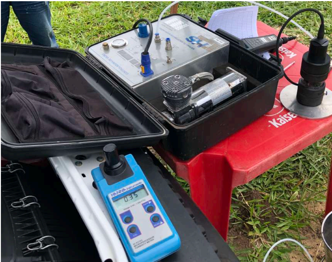
Figura VIII: Controle da Turbidez para Coleta da Água Subterrânea
