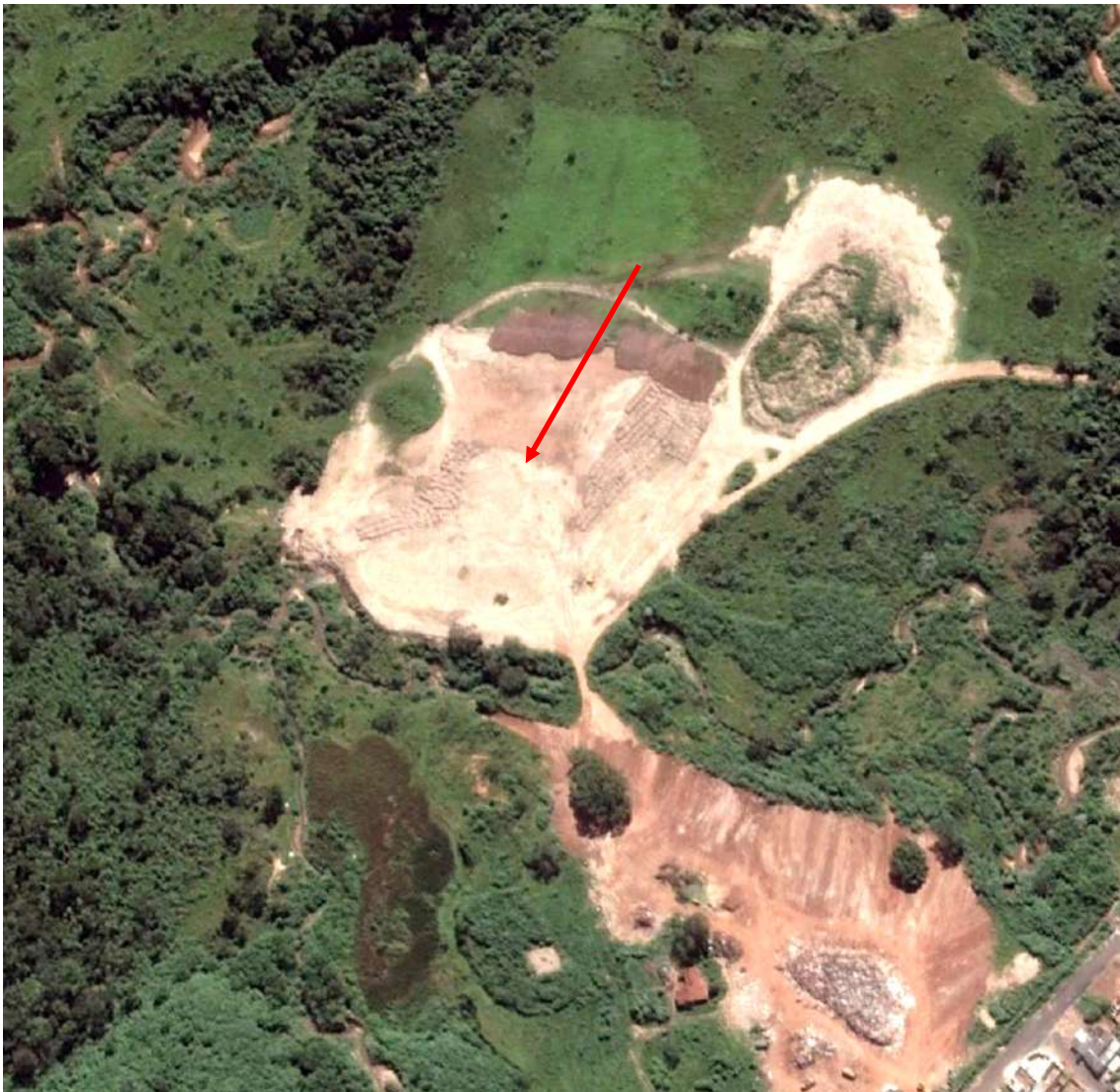
Figura XXXV: Imagem aérea de 16/04/2013 mostrando a antiga cava de extração preenchida (seta vermelha) e com o processo de cobertura de solo em execução Fonte: Google Earth
