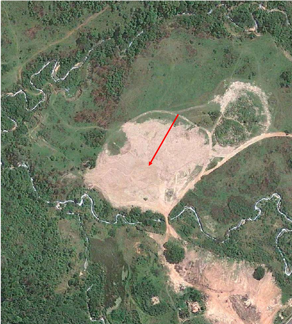
Figura XXXVI: Imagem aérea de 12/10/2013 mostrando a antiga cava de extração preenchida (seta vermelha) e coberta de solo Fonte: Google Earth
