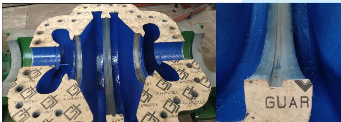
**Figura 2 - Detalhes internos da bomba e canal da placa inter estágio**
