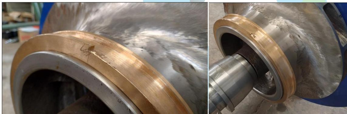
**Figura 5 - Detalhes do anel de vedação do rotor (Bronze SAE65)**
