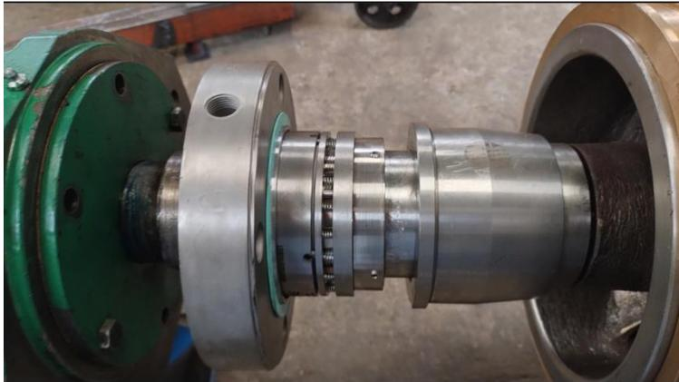
**Figura 6 - Conjunto da extremidade do eixo com detalhe do direcionador de fluxo**
