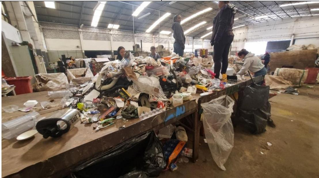
Foto 8 – Transferência dos materiais passíveis de reciclagem acondicionados nos bags para a mesa de triagem
